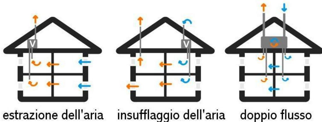
Per situazioni particolarmente severe, che possono essere individuate strumentalmente, il provvedimento descritto può rivelarsi insufficiente. In questi casi è necessario ricorrere a sistemi di areazione adeguati all'effettiva severità del problema.
