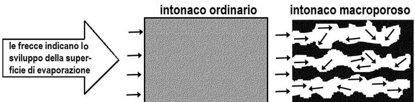
L'intonaco così formulato risulta estremamente poroso con una struttura formata da macropori e micropori, comunicanti attraverso una rete di capillari che favorisce il trasporto di acqua in fase liquida, dall'interno della struttura verso l'esterno, mediante adescamento ad opera dei capillari ed evacuazione, per evaporazione dell'acqua stessa, al livello delle porosità dell'interfaccia.
